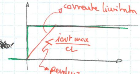
Supponendo la banda dell'opamp infinita, con un gradino in ingresso il condensatore si carica con:
