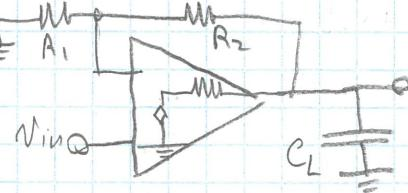
$i_{out} = i_f + i_{C_L} = \frac{V_{out}}{R_1 + R_2} + C_L \frac{dV_{out}}{dt}$  ad dire che c'è una corrente max vuol dire che c'è una pendenza max di  $V_{out}$
