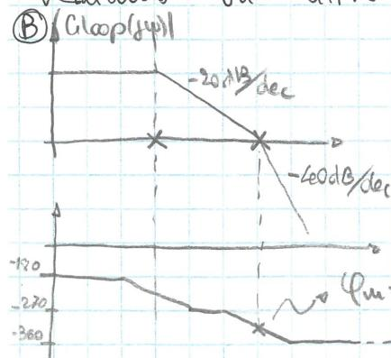
Guardando la singolarità, ho prima  $-20 \text{ dB/dec}$  (ho un polo risultante anche se ho altri poli e zeri primi che si sono compensati) e poi ho  $-40 \text{ dB/dec}$ . Questo è possibile se non ci sono zeri destri, ovvero con  $\text{Re} > 0$ . Il crit di Bode vale per poli/zeri a  $\text{Re} > 0$ .
