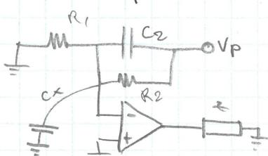
$$G_{\text{loop}}(\omega) = -\frac{R_1 \cdot A_o}{R_1 + R_2}$$
