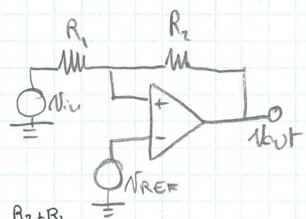
$$\text{L'ampiezza riuniva costante un traslo } V_{TH} = -L^- \frac{R_1}{R_2} + V_{REF} \cdot \frac{R_2 + R_1}{R_2}$$
