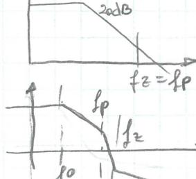
Attenzione che se  $T_p > T_z$  arrivo all'instabilità le capacità parassite sono dell'ordine di  $0,5 \div 2 \mu F$
