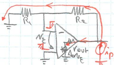
La tensione d'uscita resta fissa in tensione.
