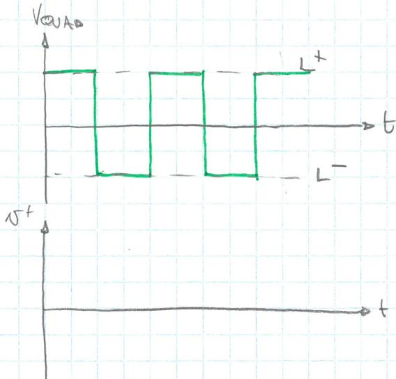
1) L'uscita del trigger per il ruotare è a  $L^+$ , si genera corrente  $i = \frac{L^+}{R}$  (il  $\oplus$  dell'opamp 1 è v.gud)
