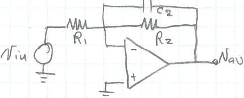
Questa capacità (poco diminuita) mi va a modificare il guadagno ideale  $G_{\text{id}}(s) = -\frac{R_2}{R_1} \cdot \frac{1}{1+sT_z} \quad T_z = R_2 C_2$
