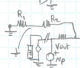
Vediamo di calcolare ora la resistenza vista in uscita.
