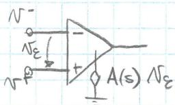
Come fatto  $A(s) \cdot V_{in}$ ? L'opamp è composto da transistor  $\Rightarrow$  ha capacità parassita (in blu)  $\rightarrow$  singolarità irreversibili. Per non avere problemi con le capacità parassite, inserisco un polo dominante tale che il residuo sia  $< 1$  nel polo della 1<sup>a</sup> singolarità irreversibile.
