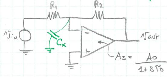
Anche se abbiamo un singolo polo, abbiamo capacità parassite che si inseriscono nel circuito.
