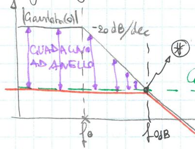
$$20 \log |G(jw)| = 20 \log |G_{\text{load}}(jw)| - 20 \log |1 - G_{\text{loop}}(jw)|$$
